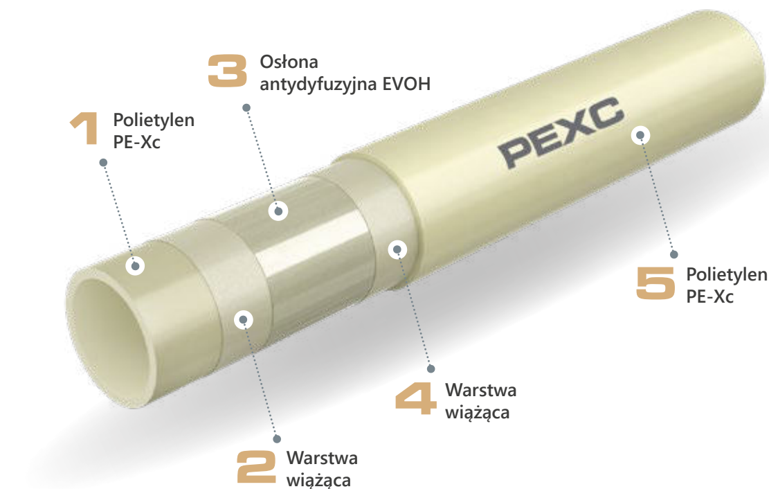
Przekrój rury PEXC z osłoną antydyfuzyjną
