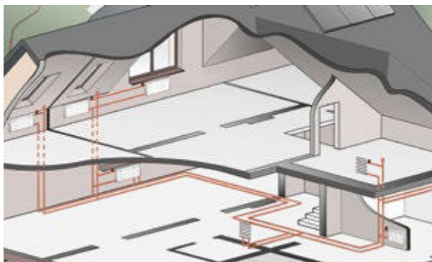
Układ „pionowy” instalacji grzewczej
