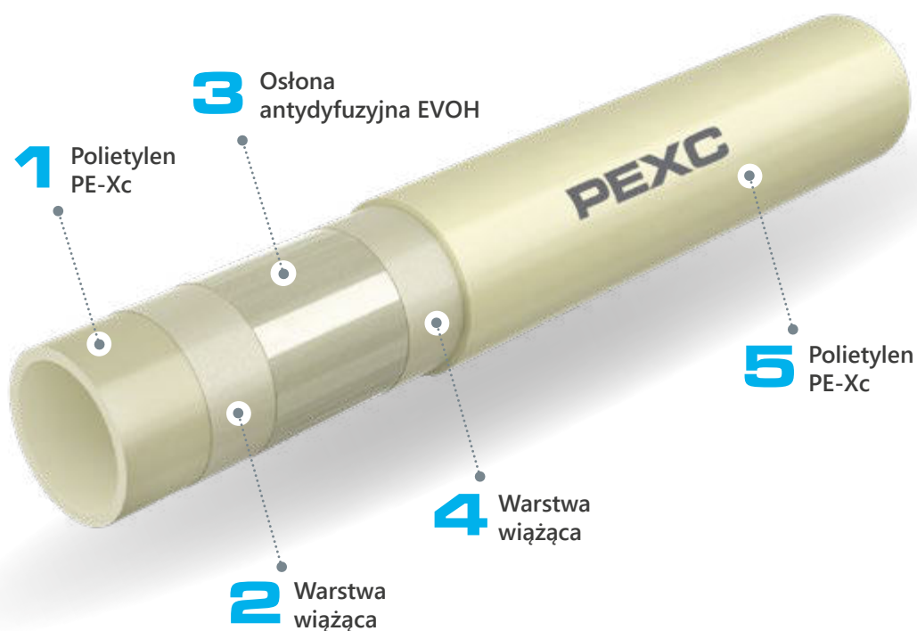
Przekrój rury PEXC z osłoną EVOH
